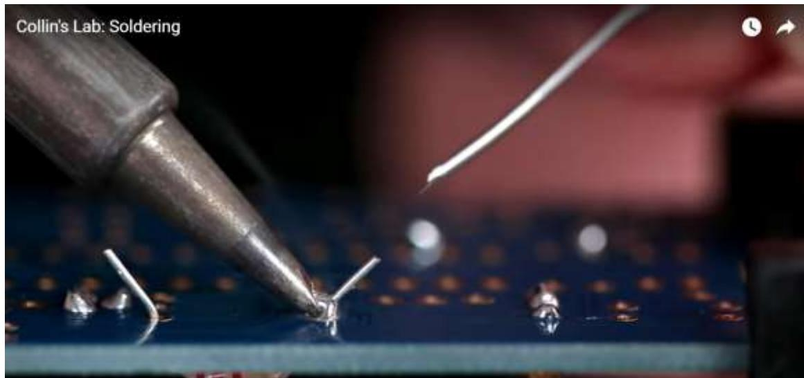
5. Kada na spoju ima dovoljno rastaljenog tinola (u pravilu utrošak 1 - 3mm dužine tinol žice), njegovo doziranje treba završiti, na način da se tinol žica odvoji od spoja. Vrh lemilice drži se još kratko vrijeme na spoju (1 do 2 sekunde), dok se rastaljeni tinol ne razlije preko čitavog spoja i poprimi konkavni oblik. U međuvremenu, i flux iz rastaljenog tinola će izdimiti.
