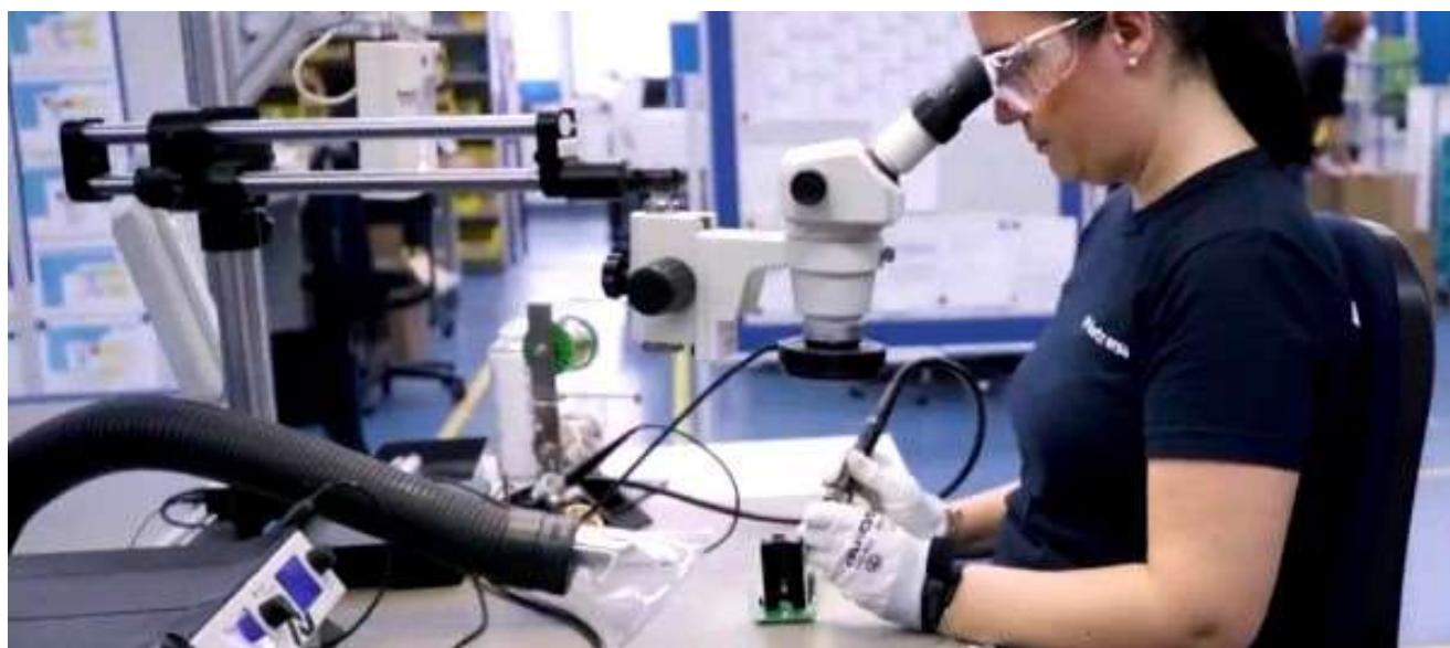
Primjer korištenja zaštitnih naočala, rukavica i ventilatora za odvođenje lemnih para u profesionalnom elektroničkom laboratoriju.
