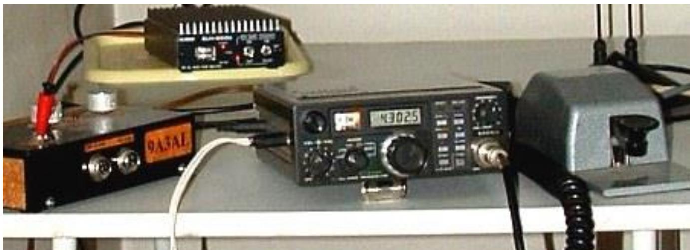
Povezivanje s FT290R izvedeno je na poziciji iza ulaznog tranzistora. Zašto? Kao prvo, koristi se ulazni filter i pojačalo prijemnog dijela uređaja. Kao drugo, i u ovom slučaju najvažnije, za vrijeme odašiljanja prijemni dio je automatski isključen, a USB modem zaštićen od prejakog signala odašiljača.
