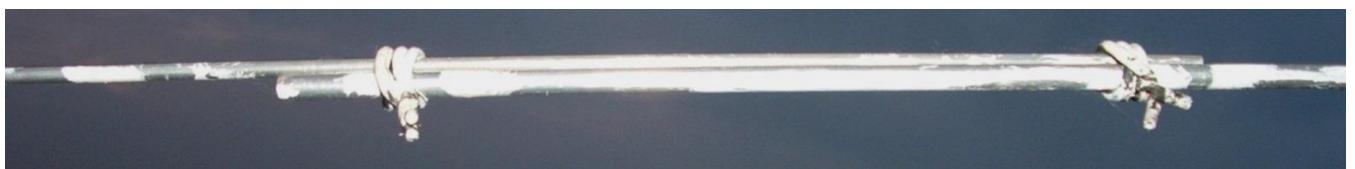
Detalji improvizirane antene. Klizač je načinjen od 2 mala nosača za police uz primjenu stakloplastike kao jeftinog i čvrstog materijala. Podesivost dužine elemenata rješena je jednostavnom improvisacijom s izoliranom bakrenom žicom.
