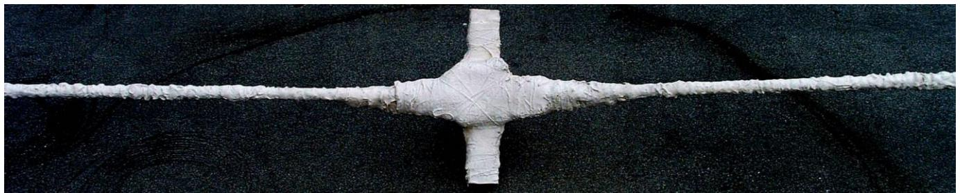
Materijal od staklenih vlakana se obmata oko Al elementa uz korištenje konca i premazuje poliesterskom smolom. Stvrdnuta površina je gruba. Može se dotjerati s turpijom ili brusnim papirom. Postignuta čvrstoća i žilavost slična je kao kod ribičkog štapa iste debljine.
